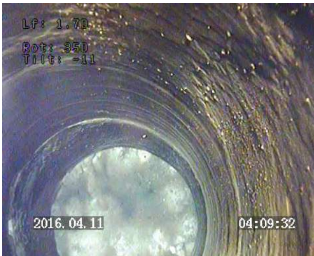
Prof 1.70 m : vision axiale / buse pleine en béton / parois propres
