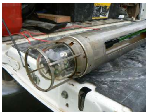
Figure 7 - Planche photographique du matériel de diagraphie utilisé pour les inspections caméra.
