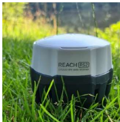
Figure 4 - GPS Reach RS2 utilisé pour le levé GPS des ouvrages
