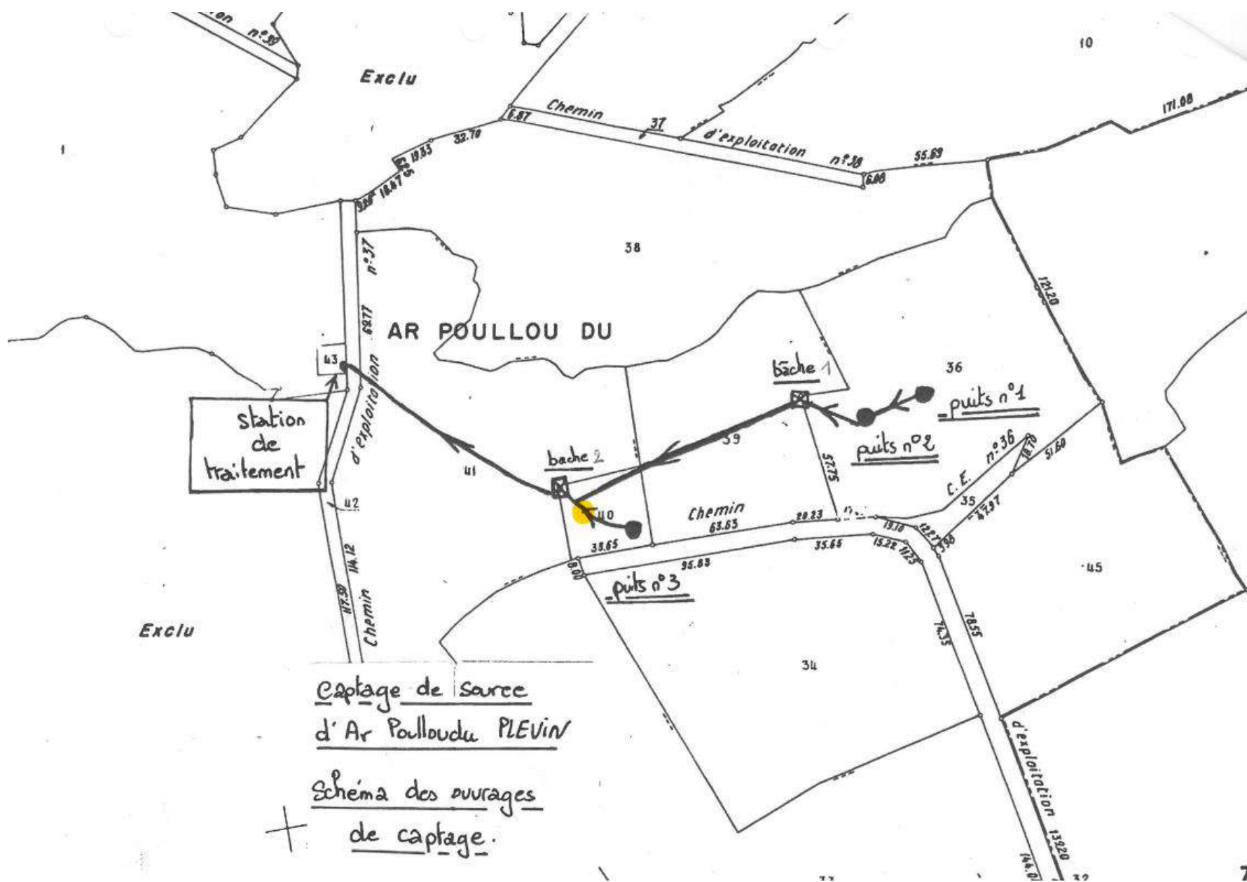
Figure 5 - Plan disponible du fonctionnement hydraulique du site de Ar Pouloudu à Plévin (document SMKBAEP)
